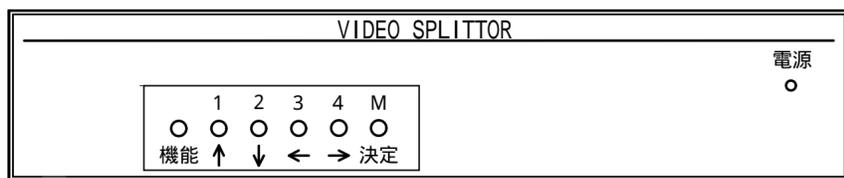
本機は、テレビカメラ4台を接続した、合成画面に内部発生ラインを重ね表示します。
